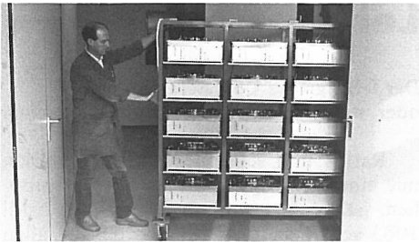
18 Dauerlaufboxen stehen zur Verfügung. Jede Box fasst 2 Wagen à 15 Geräte. Ein Raumthermostat sorgt während der 72 Dauerlaufstunden über ein Zu- und Abluftsystem für konstante Temperaturbedingungen.
