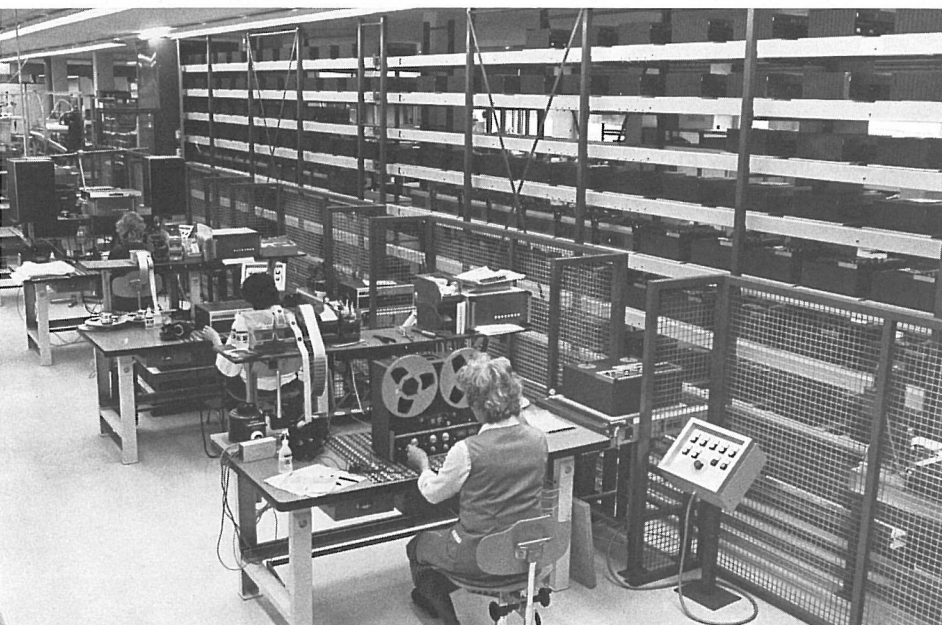
Die Arbeitsplätze der Qualitätskontrolle vor der Gesamtanlage. Die fertig kontrollierten Geräte werden auf ein links an der Fensterfront vorbeilaufendes Förderband gestellt, das am Paktisch im Verkaufslager endet.
