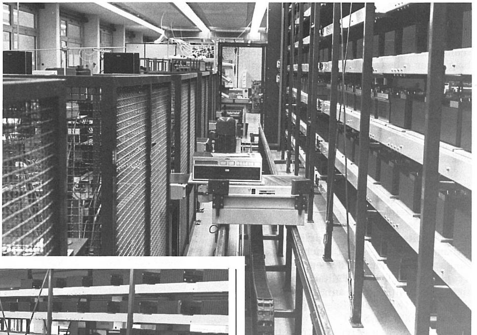
An den Gerätespeicher gekoppelt sind 5 Messplätze der Qualitätskontrolle. Von jedem Prüfplatz aus können Geräte per Knopfdruck angefordert werden. Ein Entnahmelift holt das gewünschte Gerät aus der entsprechenden Speicherbahn. Mittels einer speziellen Einrichtung wird das Gerät vom Lift auf einen Verschiebewagen gegeben, der es zum adressierten Prüfplatz fährt und dort direkt auf den Arbeitstisch schiebt.
