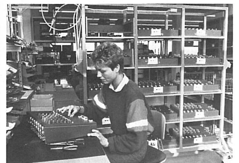
Fertig montierte Geräte werden in den "Dauerlaufwagen" gestellt. Jede dieser installierten und fahrbaren Einheiten fasst 15 Revox-Geräte beliebigen Typs. Das Bild zeigt den Arbeitsplatz "Kleinmischpult" mit Dauerlaufwagen.
